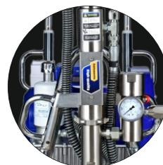
7. Увеличьте давление так, чтобы гидравлический мотор начал работать, и дайте жидкости циркулировать в течение 15 секунд; уменьшите давление и поверните перепускной клапан заливки в горизонтальное положение.
